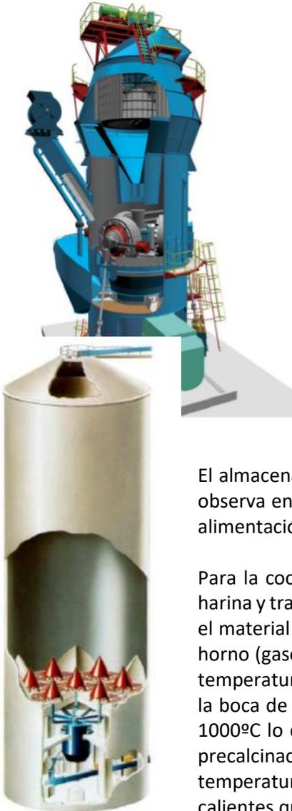
**Molienda:** Para la molienda de materias primas (crudos), se utilizará un molino vertical de rodillos. La composición química estará monitoreada continuamente. Las velocidades de alimentación se ajustarán automáticamente cada 5 minutos para asegurarse de que la producción de harina cruda acumulada cumpla con los requisitos, realizándose análisis químico del Clinker.
